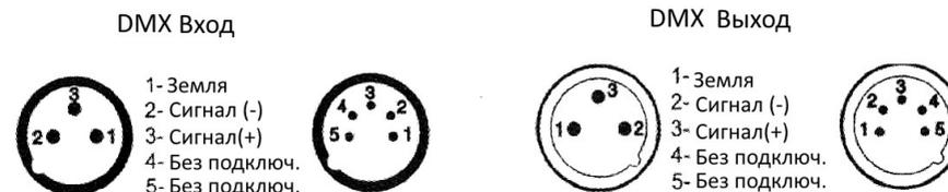
Для предотвращения помех при передаче DMX сигнала, используйте как можно более короткий кабель для соединения устройств. Порядок подключения устройств не отражается на их адресе в цепи DMX, таким образом, устройство, с назначенным порядковым номером 1 DMX, может находиться любым по счету в цепи устройств.
